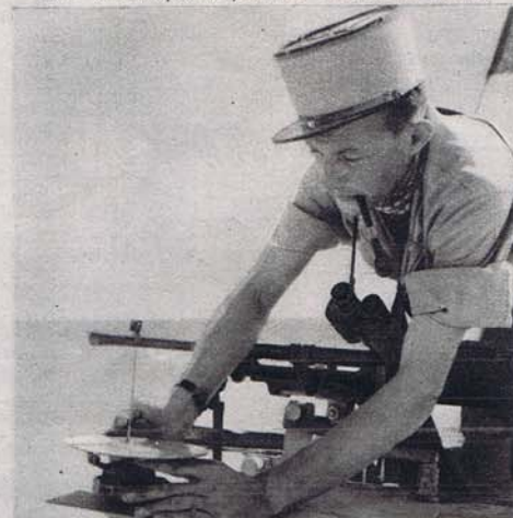
Le compas solaire est le plus souvent le seul moyen de se diriger dans le Western Desert
